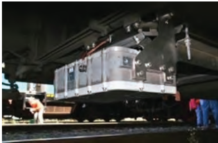
Slika 13. Nailazak vlaka na eurobalise-u (odašiljač i prijemnik)
