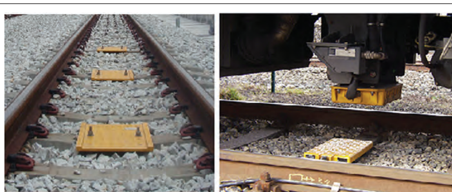
Slika 12. Način postavljanja Eurobalise-a
